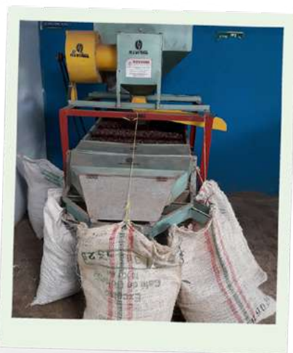
B. Seleccionadora de grano mecanizada (Monitor).
