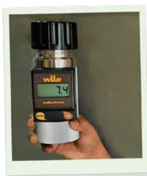
A. Medidor de humedad portátil.
